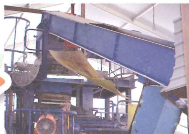
玻璃樽會透過運輸帶送往音頻破碎系統進行破碎
