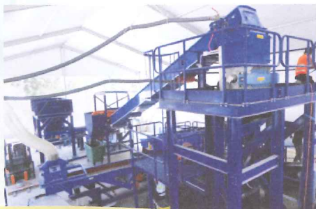
機器頂部便是音頻破碎系統，只需短短一分鐘便能將玻璃容器碎成砂。
